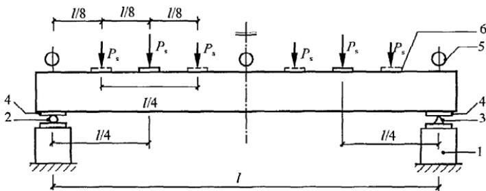
图 F. 3. 1 受弯构件试验
