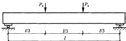
图 G. 3. 3 试样三分点侧立抗弯试验
