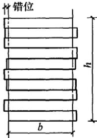
图 5.3.1 外观 C 级层板
