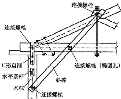
图 4.2.14 屋架与木柱的连接
